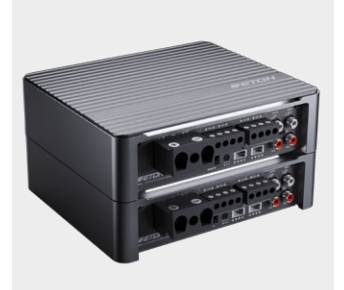
Stackfunktion für mehrere Verstärker, LED Lightbar zeigt den Status an: weiß = Normalbetrieb rot = Protect, Störung
