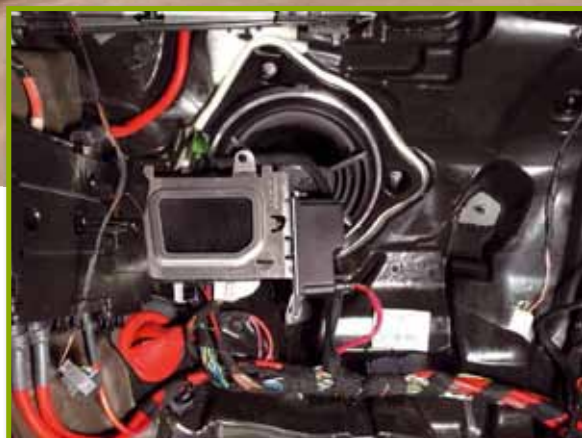
Der Tieftöner/Subwoofer ist im Beifahrerfußraum verbaut. Er ist hinter Steuergeräten und dem dicken Teppich versteckt
